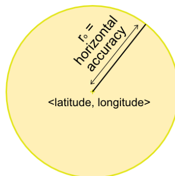
Figure 14 : Schématisation de la géolocalisation L'utilisateur se trouve quelque part n'importe où dans ce cercle
